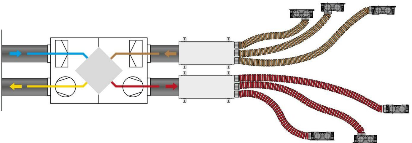
In questa tipologia di distribuzione, l'immissione e la ripresa dell'aria sono realizzate tramite delle cassette di distribuzione (plenum) alle quali sono collegate le canalizzazioni che servono le bocchette di mandata e di ripresa, secondo la schematizzazione rappresentata.
